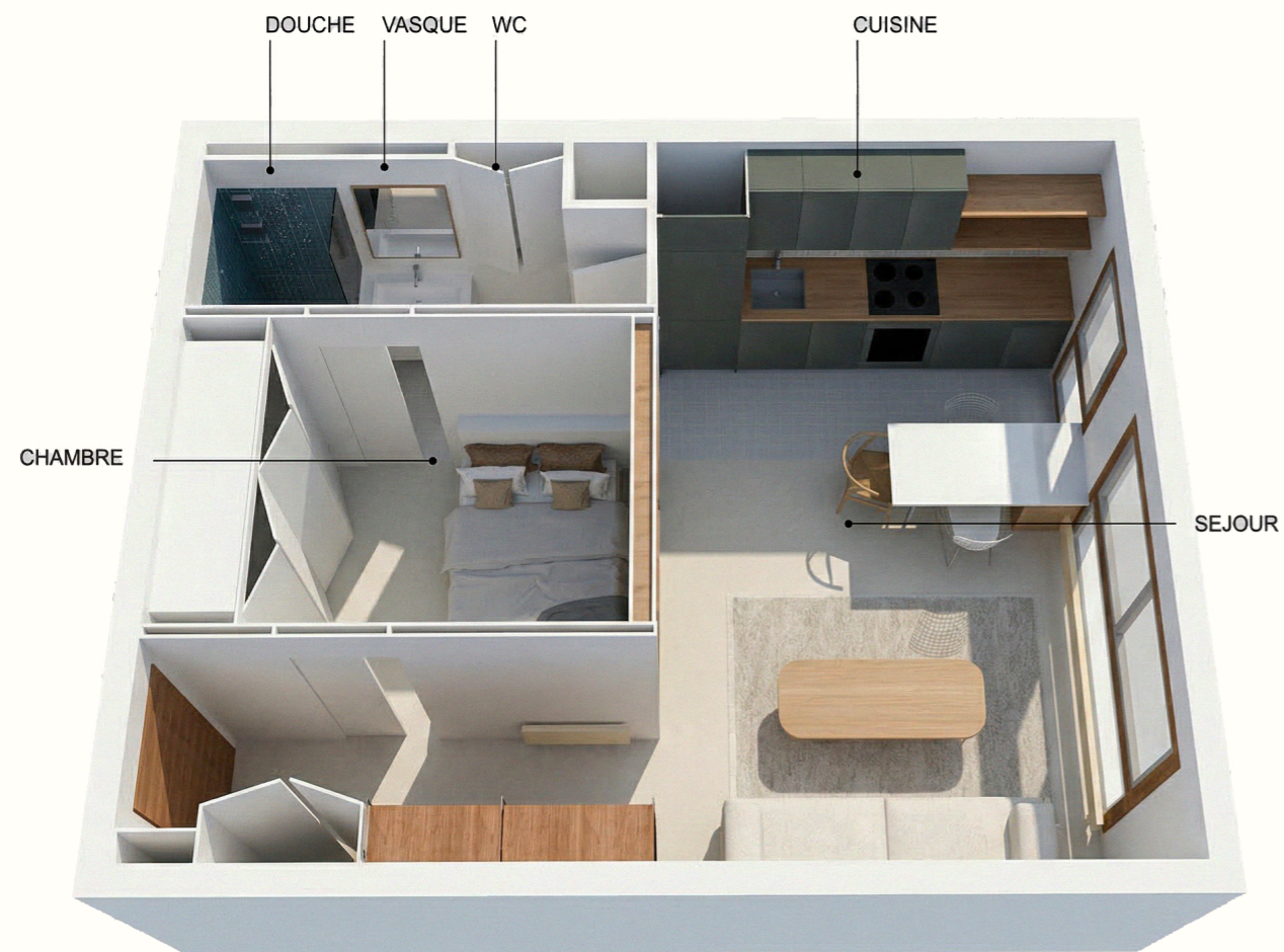
Organisation du studio: espace d'entrée défini avec des placards intégrés, pièce de vie avec cuisine ouverte, création d'une chambre «cabine» derrière une verrière bois sur-mesure, salle d'eau accessible depuis la chambre et depuis la cuisine, plan fluide
