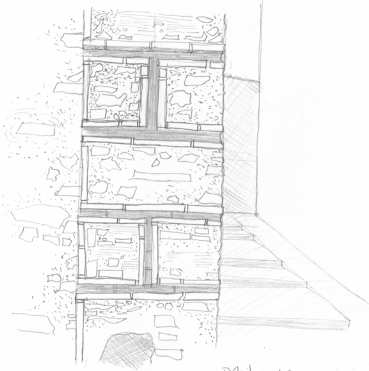
Détail du chârnage d'angle Rue G. Mazzini - Vicotizzini à Tiriolo, Calabre, Italie
