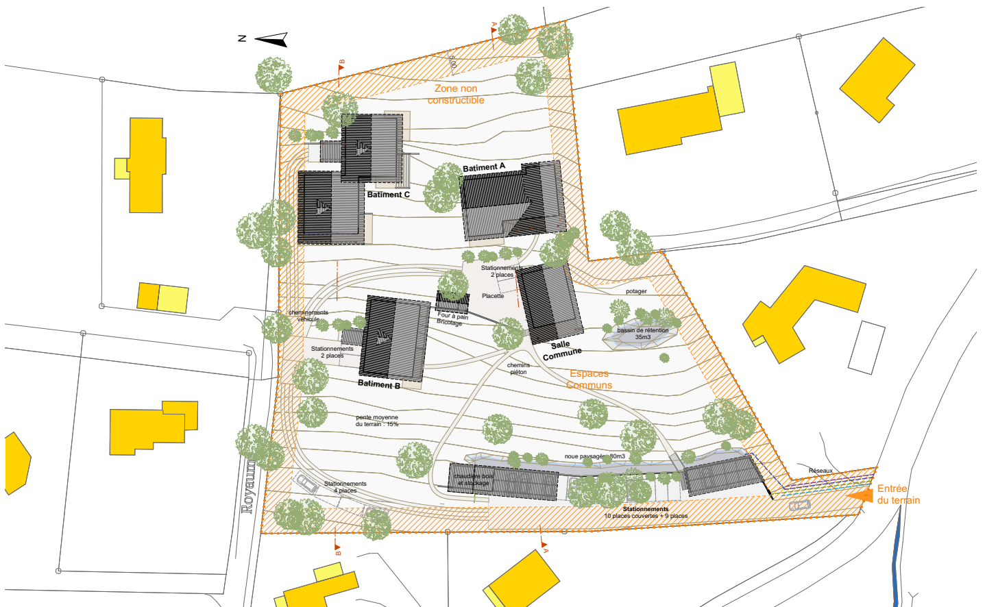
Plan Masse des 10 logements (4 logements possibles plus tard sur le bas du terrain)
