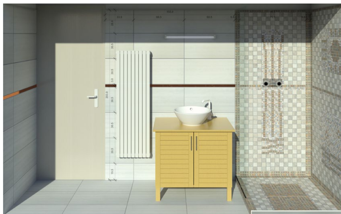
Calepinage carrelage salle de bains
