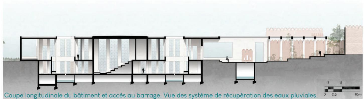
Coupe longitudinale du bâtiment et accès au barrage. Vue des système de récupération des eaux pluviales.
