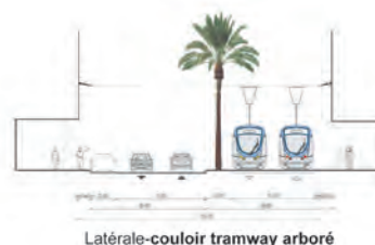
Latérale-couloir tramway arboré
