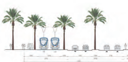
Latérale-couloir tramway arboré
