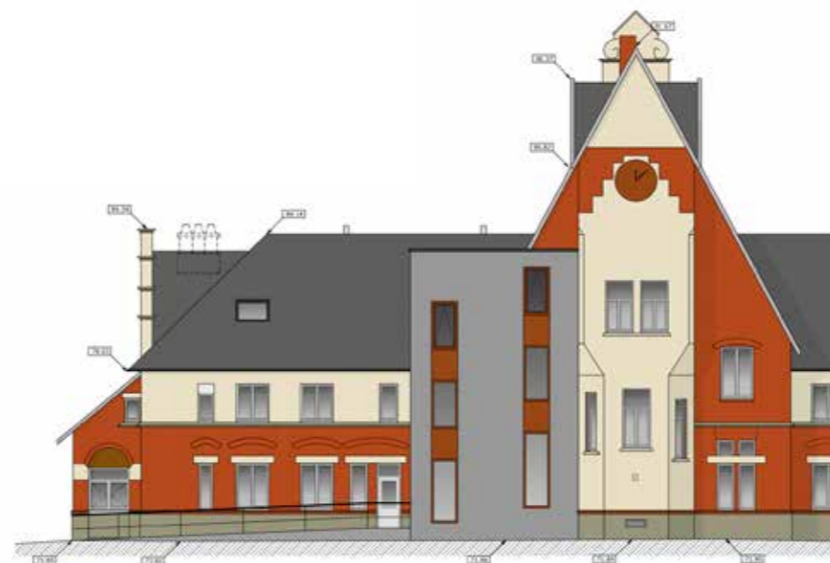
Mise en place d'un ascenseur, de rampes d'accès dans le cadre de la mise en conformité accessibilité.
